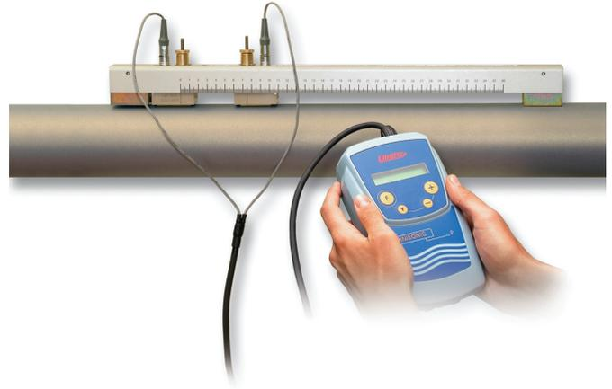
Das **MINISONIC P** misst die Geschwindigkeit und den Durchfluss einer Flüssigkeit mittels der **Laufzeitdifferenz** von Ultraschallimpulsen. Dieses Feldgerät ermöglicht die Durchflussmessung von Wasser unterschiedlicher Qualität, von verschiedenen Mineralölprodukten, von nahrungsmitteltechnischen oder petrochemischen Prozessen.
