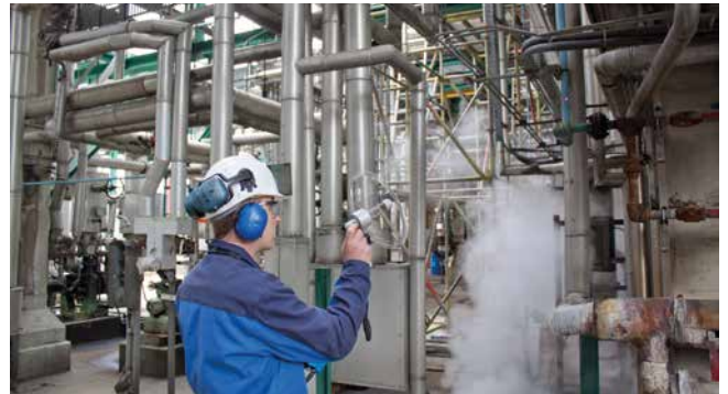
SDT 200 Leckagenortung mit Parabolspiegel
