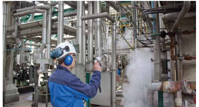
SDT 200 Leckagenortung mit Parabolspiegel
