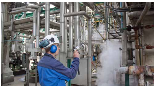
Mit ihrem Hörsinn haben Menschen jahrhundertlang Probleme gefunden. Mit Ultraschall wird diese Fähigkeit gesteigert, da man mit einem breiteren hörbaren Frequenzbereich arbeitet.
