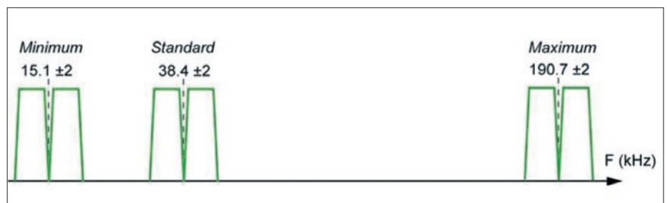
Die Frequenzbänder werden in Abhängigkeit der zu ortenden Geräusche gewählt
