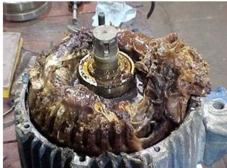
Der zweite zu vermeidende Fehler ist, zu viel oder zu wenig Schmierfett aufzubringen. Zu viel Fett baut Druck auf und drückt die Rollenelemente durch den Flüssigkeitsfilm und gegen den Außenring. Der Motor muss viel härter arbeiten, um die Rollenelemente durch einen Morast an Fettschlick zu drücken. Wozu braucht man mehr physische Energie? Sorgloses Sprinten durch knöcheltiefes Wasser entlang der Küste oder schuften in mehr als metertiefem Wasser vor der Küste?
